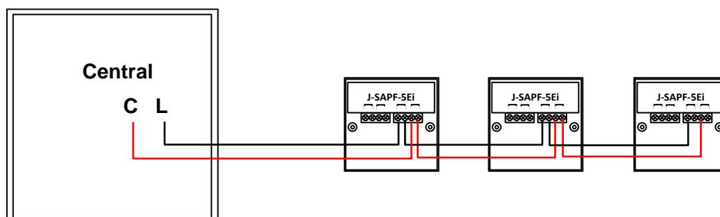
➤ **INSTALAÇÃO SIMPLES, CABO 2 X 1,5MM<sup>2</sup>, LIGAÇÃO COM RESISTOR DE FINAL DE LINHA:**
